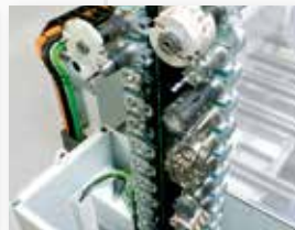
Ketten-Werkzeugmagazin mit 16 oder 32 Plätzen
