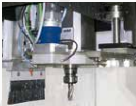
Frässpindel HSK F63 16 oder 26 kW
