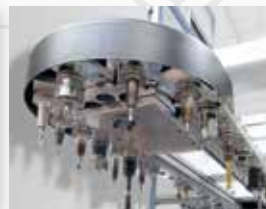
Ketten-Werkzeugmagazin mit 33 oder 51 Plätzen
