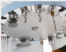
Drehteller-Werkzeug- magazin mit 20 Plätzen
